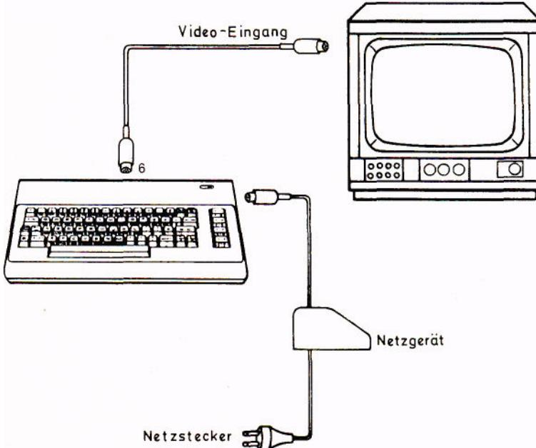
Zum Empfang normaler Fernseh-Sendungen müssen Sie das Video-Kabel in der Regel entfernen.
